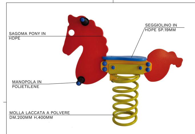
TUTTI GLI ELEMENTI DI FISSAGGIO, VITI, DADI, RONDELLE ECC. SONO IN ACCIAIO ZINCATO E PROTETTI DA GHIERE E TAPPI IN POLIETILENE
